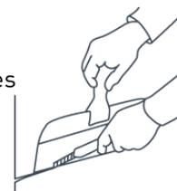
Angle sortant : Poncer légèrement les angles à l'aide d'une toile-émeri ( $\geq$  P 240), rabattre, éventuellement couper ou utiliser une baguette d'angle.
