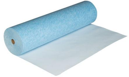
PrimaCover Active est un non-tissé en polyester autoadhésif et à respiration active. La membrane multicouches située sur la face supérieure laisse l'humidité s'échapper et empêche toute pénétration de liquides. Ce produit régulateur d'humidité est spécialement conçu pour les sols sensibles à l'humidité, tels que les sols en pierre naturelle et sols coulé, ou bien les revêtements de sol posés dans des endroits humides.
